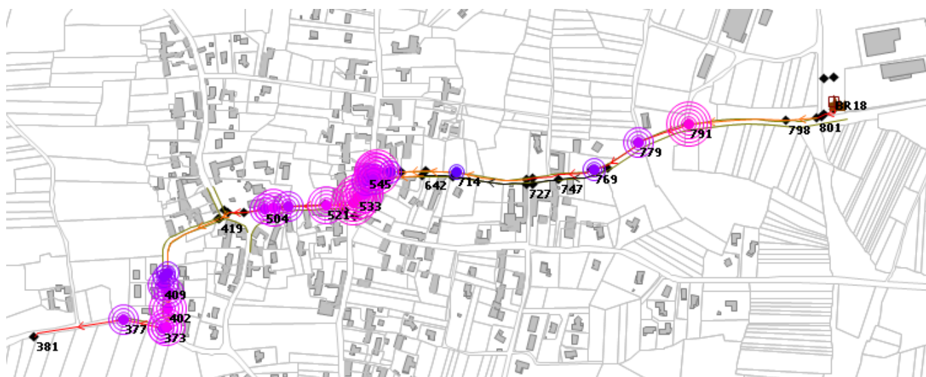
Résultats de la modélisation hydraulique pour une occurrence trentennale
